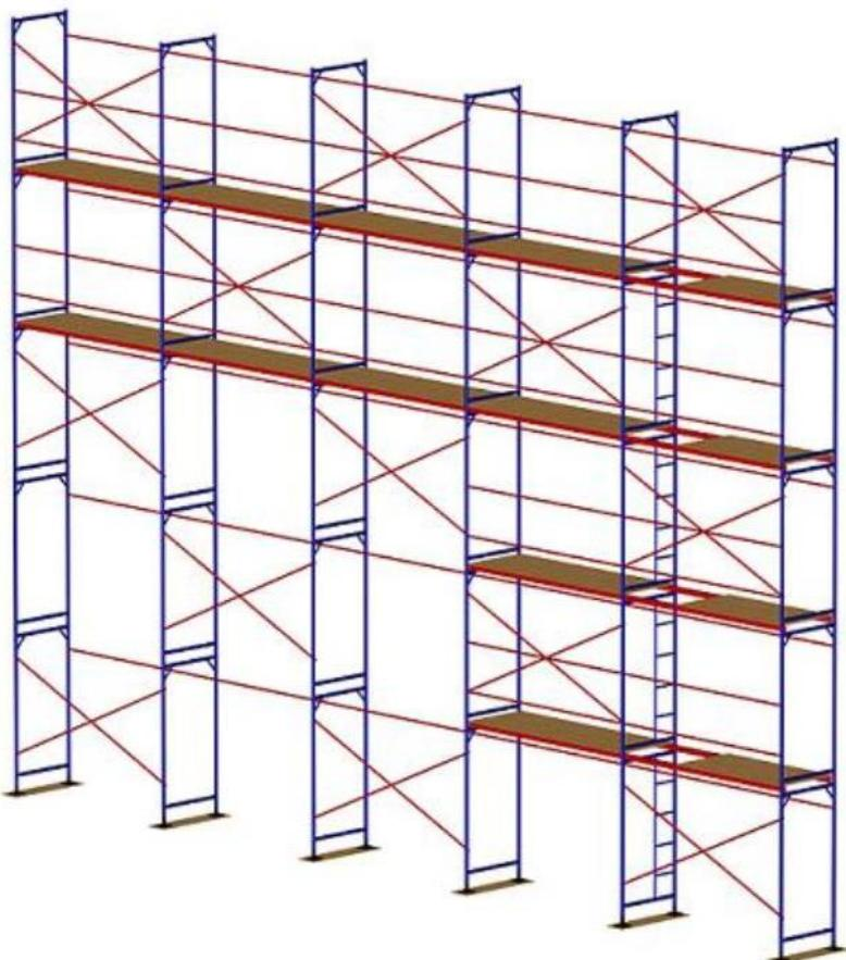
Леса типа ЛРСП представляют собой леса рамные строительные приставные (далее леса), выполненные в соответствии с требованиями ГОСТ 27321-2018 применяемые при возведении, реконструкции и ремонте зданий и сооружений высотой до 60 метров, каменной кладки стен зданий высотой до 20 метров, а также для размещения рабочих и материалов на участках производства строительно-монтажных работ.
